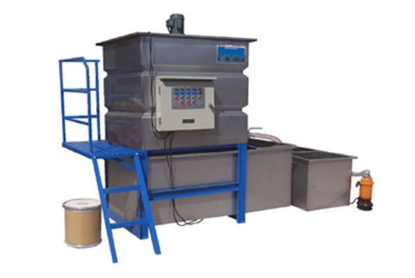
图 4-3 网版清洗废水处理设备示意图
